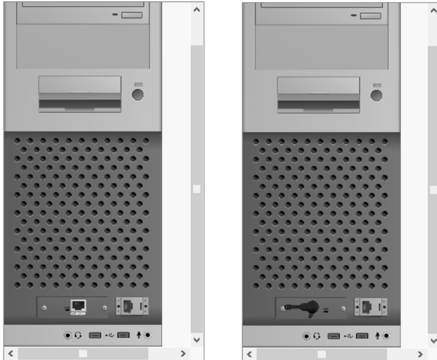
Figura M.9. Desinstalación de la tarjeta FastEthernet e instalación de la tarjeta inalámbrica en el ordenador PC0.
